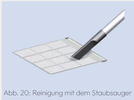
Abb. 20: Reinigung mit dem Staubsauger
